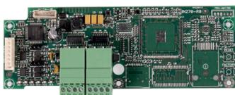
**PREVIDIA-C-COM** ofrece dos puertos RS232 y dos puertos RS485 donde conectar comunicadores remotos mediante los protocolos indicados en la tabla.
