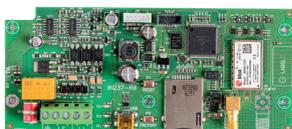
Gestiona comunicaciones remotas a través de línea telefónica cableada y red GSM 3G. Capaz de gestionar llamadas de voz, grabar hasta 100 mensajes de voz, mensajes de texto SMS automatizados y gestionar llamadas digitales mediante los protocolos más utilizados.
