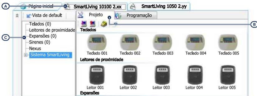
Depois de aberta a solução do sistema a ser projetado [A], na ficha à direita "Projeto" [B], é possível selecionar um ícone do tipo de periférico a configurar e arrastá-lo na parte desejada da estrutura ramificada [C].
