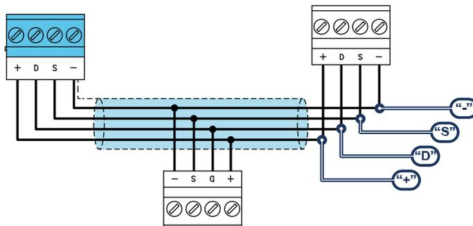
Os periféricos das centrais Inim Electronics devem ser conectados à unidade central através do I-BUS.
