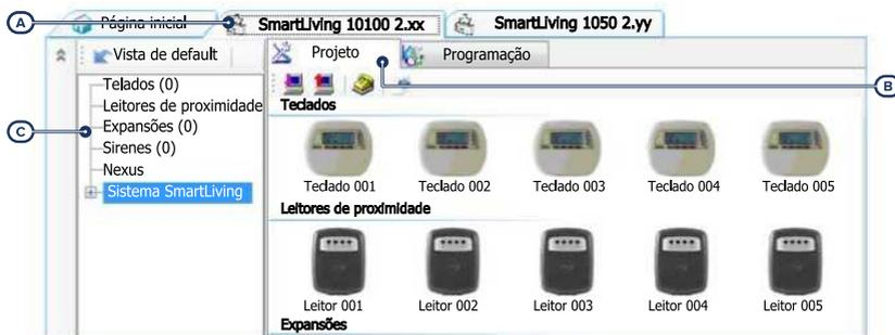
Depois de aberta a solução do sistema a ser projetado [A], na ficha à direita “Projeto” [B], é possível selecionar um ícone do tipo de periférico a configurar e arrastá-lo na parte desejada da estrutura ramificada à esquerda [C].
