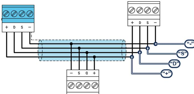
Los periféricos de las centrales Inim Electronics se conectan a la unidad central a través del I-BUS. La conexión entre la central y sus periféricas se produce con un cable blindado de 4 (o más) cables.
