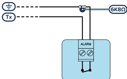
Se se deseja detetar a sabotagem do sensor, é necessário conectar o terminal “Tamper” do sensor a uma zona independente “24h” da central.
