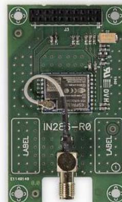
O módulo opcional PrimeWiFi permite equipar as centrais da linha Prime com conectividade Wi-Fi. Integra-se na placa principal da central Prime e fornece à central uma conexão wireless à rede Wi-Fi doméstica ou empresarial. A conectividade à rede permitirá ao instalador a programação remota e a supervisão do sistema utilizando o software Prime/STUDIO e ou a conexão ao cloud INIM.
