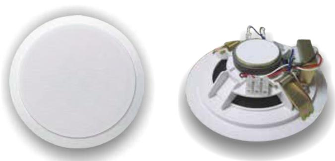
Le plafoniere serie **C51** sono costituite da una struttura in ABS con griglia in metallo verniciata bianco RAL 9016. Caratterizzate da dimensioni compatte e da un'ottima resa acustica, sono dotate di comodi e robusti ganci a molla, che consentono un fissaggio rapido e sicuro al controsoffitto. Sono fornite complete di trasformatore per il collegamento a linee a tensione costante 100 V con tagli di potenza selezionabili.
