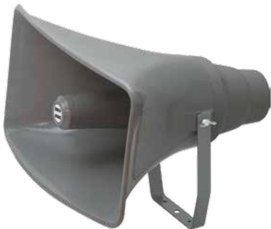
Le trombe esponenziali **TR1-B**, **TR2-B** e **TR3-B** sono realizzate in moplen di colore grigio, sono infrangibili e resistenti agli agenti atmosferici. Sono dotate di staffa orientabile per il fissaggio ed hanno una calotta di chiusura posteriore in grado di accogliere le unità magnetodinamiche **UT35** ed **UT60** ad impedenza oppure le unità **UT60-T** con trasformatore 100V, fornibili a parte (fare riferimento alla relativa tabella tecnica).
