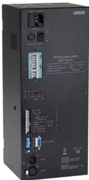
La peculiarità di questi amplificatori consiste nella capacità di sopportare la presenza di elevate tensioni tra alimentazione di rete/uscite altoparlanti e telaio, che possono arrivare fino a 4 kV. Questa caratteristica aumenta la sicurezza dell'impianto, impedendo che un'eventuale scarica sulla rete o sulle connessioni altoparlanti possa risalire la catena audio e provocare quindi gravi danni a cose o persone.
