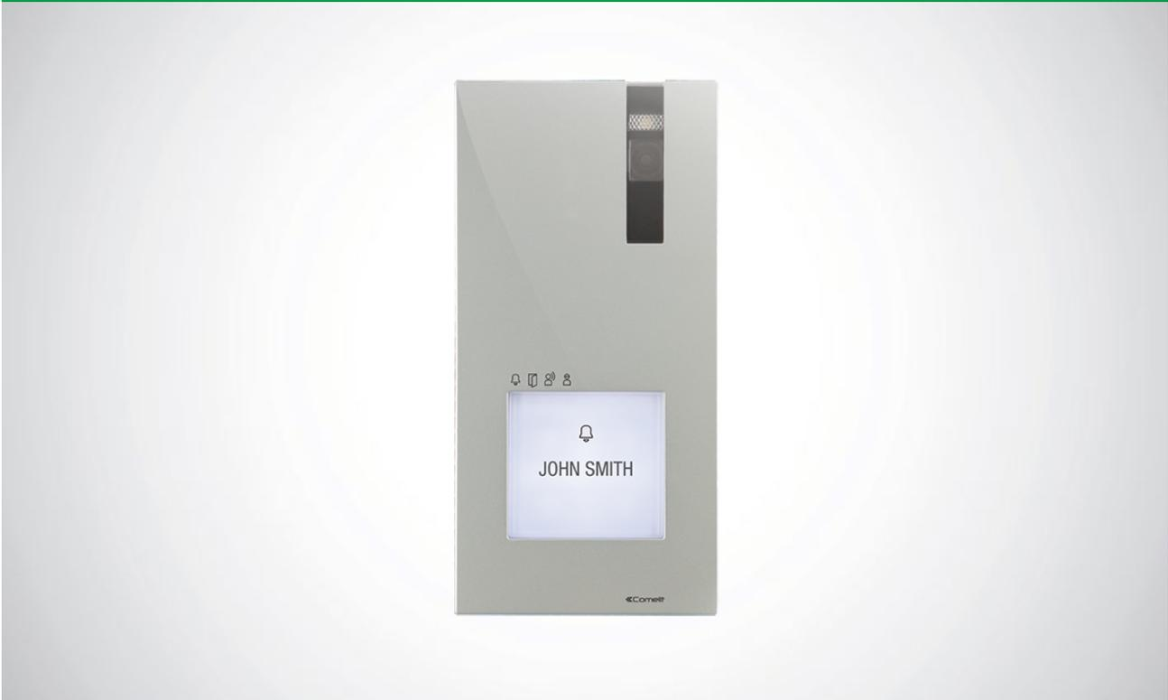
Posto externo vídeo-intercomunicador de parede, série Quadra. Pannel frontal em alumínio moldado, câmara a cores e LED único para iluminação nocturna. Teclas capacitivas que permitem programar 1 a 4 teclas de chamada através de dip switch. LED de sinalização de chamada realizada, abertura da porta activada, som activado e equipamento ocupado. Regulação do volume do altifalante e equilíbrio do som. Alimentação PoE. Dimensões: 95x195x28 mm.
